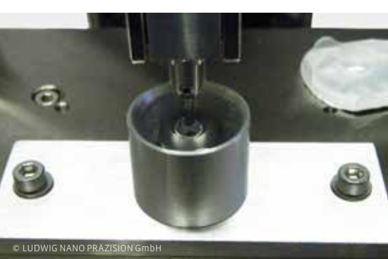
Microhärtemessung an Kontaktlinsen
